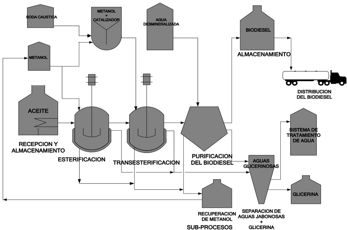
Figura 6. Flujograma del proceso de elaboración del biodiésel.
