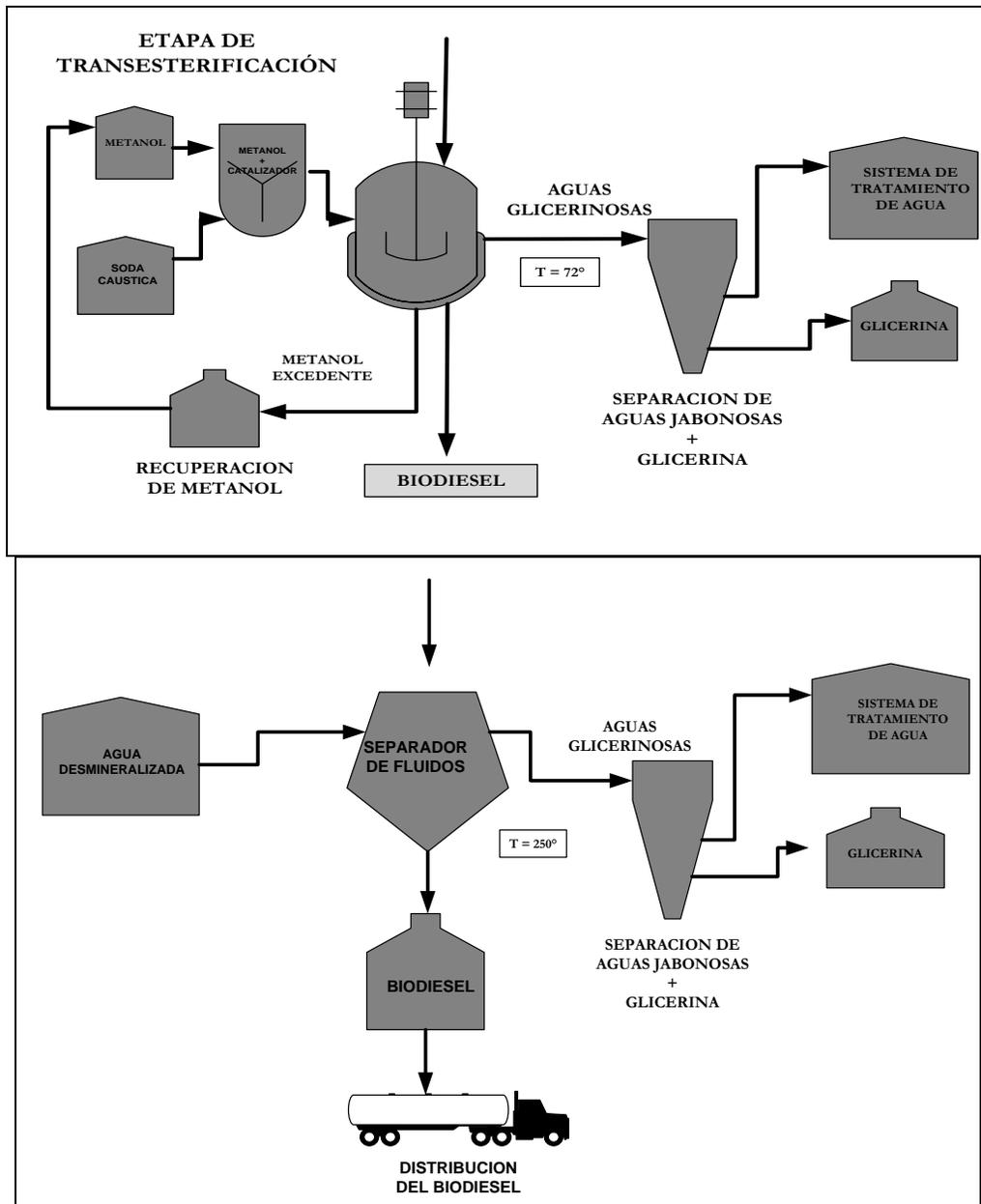
Figura 7. Diagrama de entradas y salidas del proceso de producción de biodiésel
