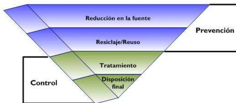
Figura 1. Esquema de los niveles de reducción de contaminación<sup>1</sup>
